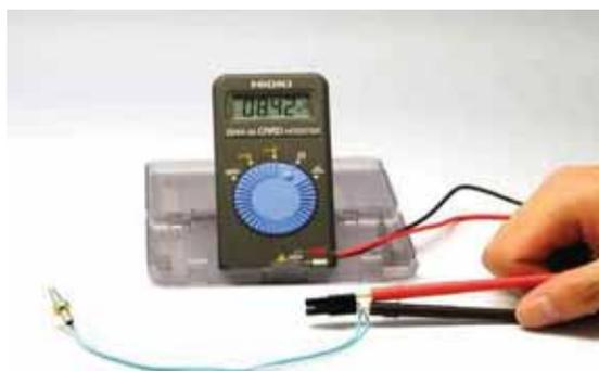
3) Если значение сопротивления, измеренное у датчика температуры, не совпадает со стандартными значениями, температурный датчик следует заменить. (Если измерять сопротивление температурного датчика, держа его в руках, то значение сопротивления примерно 5~6 kΩ будет считаться нормой.)
