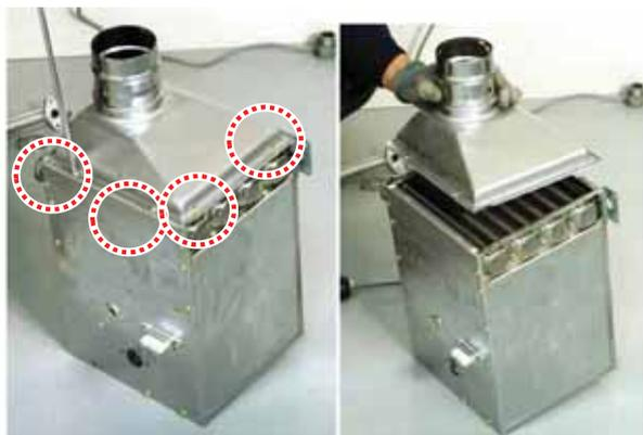
4) Выкрутите 9 винтов, скрепляющих крышку камеры сгорания.
