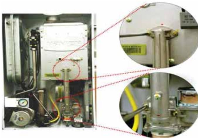
2) Выкрутите 11 винтов на передней части камеры сгорания.
